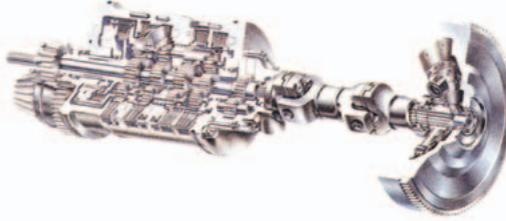
**Efficient HYDROSHIFT Transmission:**
