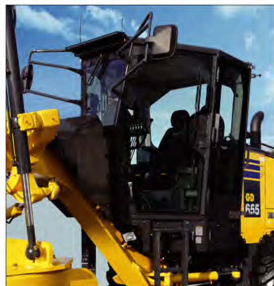
โครงสร้างคานีรภัยป้องกันการพลิกทงายของตัวรถ (ROPS - Roll Over Protective Structure) (อุปกรณ์ละลายน้ำแข็งและที่ปิดน้ำฝนแล้วเป็นจังหวะ)
