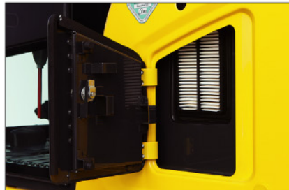
ไส้กรองไฮดรอลิก (กรองแบบฮิลโค ไวท์)
