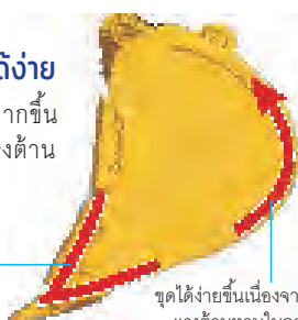
ขอบเป็นมุมแหลมเพื่อเพิ่มความสามารถในการขุด
