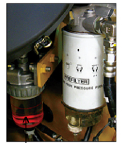
กรองดักน้ำเสริม (เพิ่ม)
